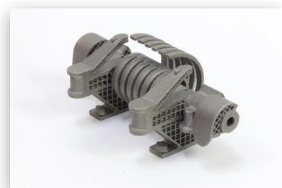
人工衛星のソーラーパネル展開用 ヒンジ(一体成型により軽量化と耐 久性を向上)
