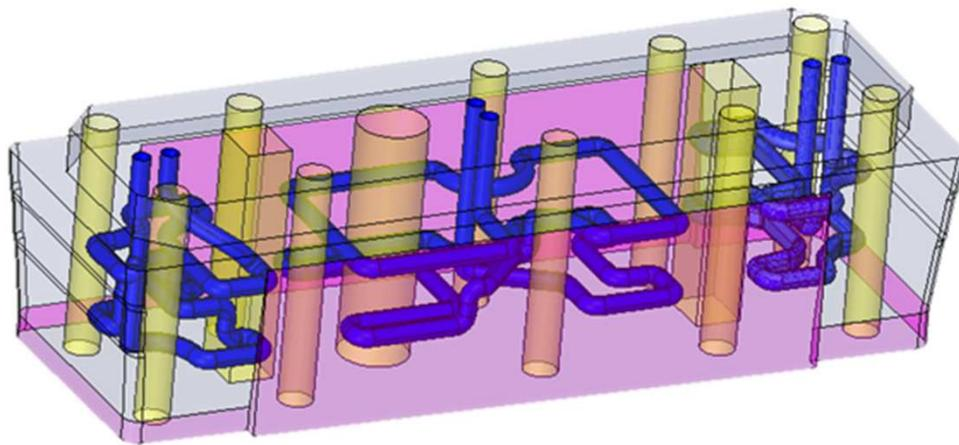
コンフォーマル冷却金型とは、形状に合わせて配置された内部冷却路によって均等な冷却性能を有します。品質向上、生産性向上、さらにはエネルギー消費量削減につながります。
