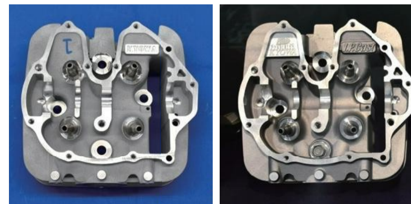
左が3Dプリンターで造形したシリンダーヘッド。右はダイキャスト製。見た目も、そんな色ない
